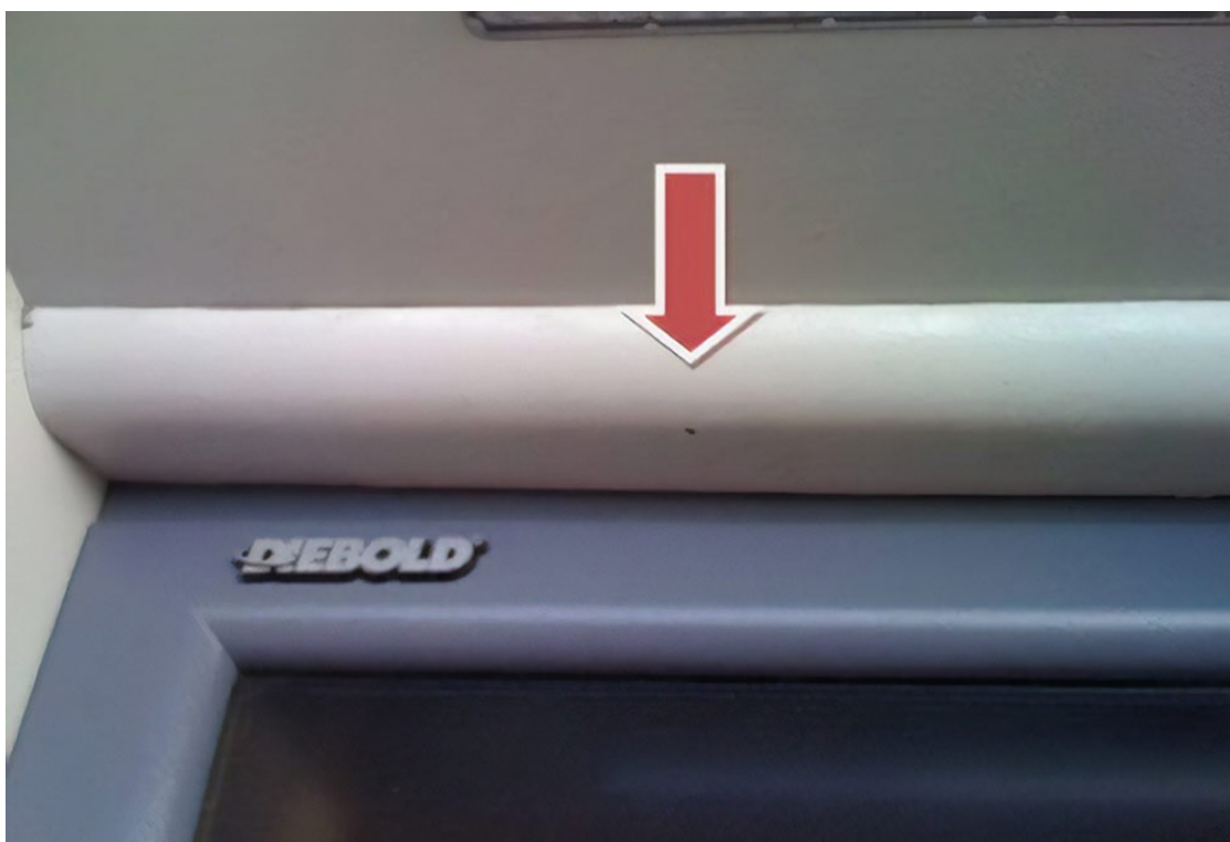
Камера в фальш-панели под козырьком банкомата:
