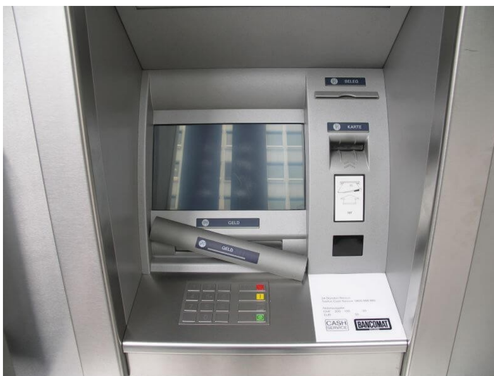
Камера в фальш-панели под экраном:
